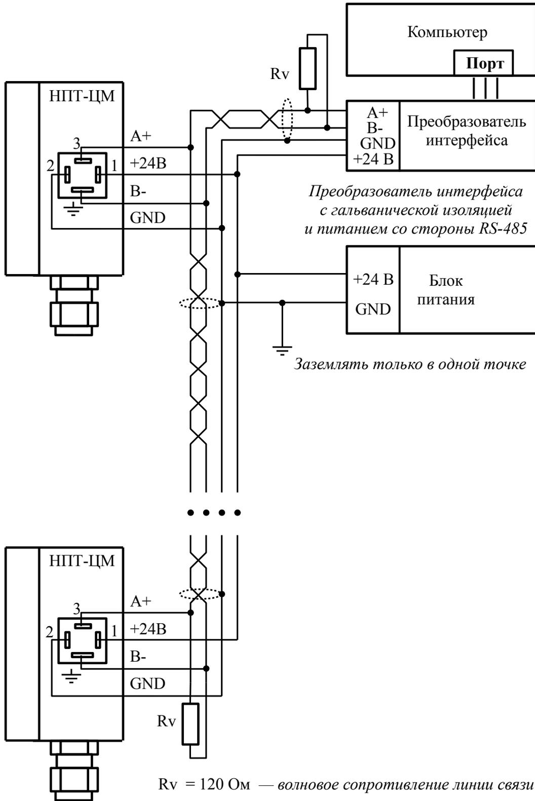
Рисунок В.3 - Включение преобразователей в локальную сеть
