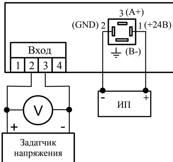
Рисунок 3.1 - Схема подключения при калибровке (поверке) преобразователя НПТ-хЦМ по напряжению (по сигналу термопары)
