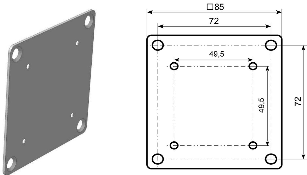
Рисунок И.1 - Пластина крепежная
