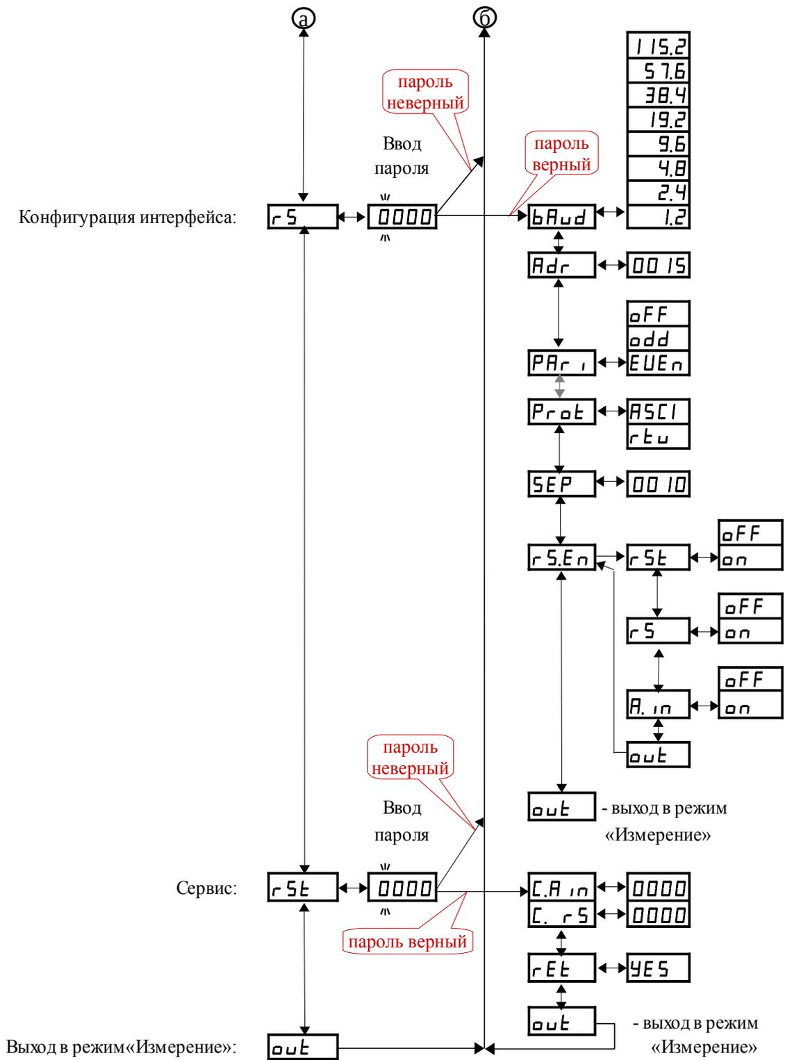
Рисунок Д.1 - Алгоритм режима «Настройка»
