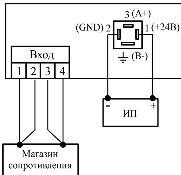
Рисунок 3.2 - Схема подключения при калибровке (поверке) преобразователя НПТ-хЦМ по сопротивлению (по сигналу термометра сопротивления)
